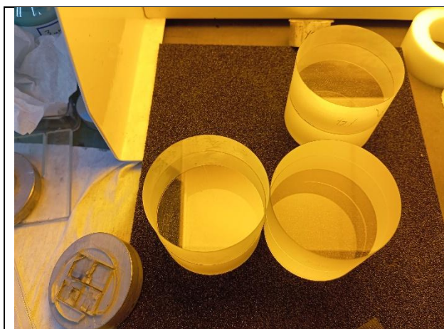
Fig.1. Assemblages de verre de silice dont les surfaces ont été traitées par plasma (J. Debray, Institut Néel, Grenoble)
